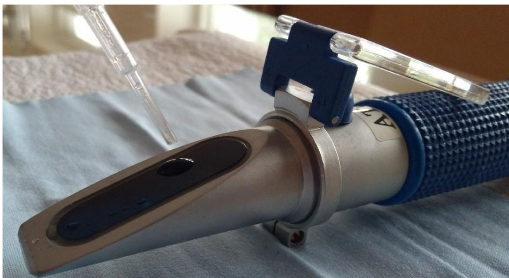
Рис. 6 - Нанесение исследуемой пробы на линзу
