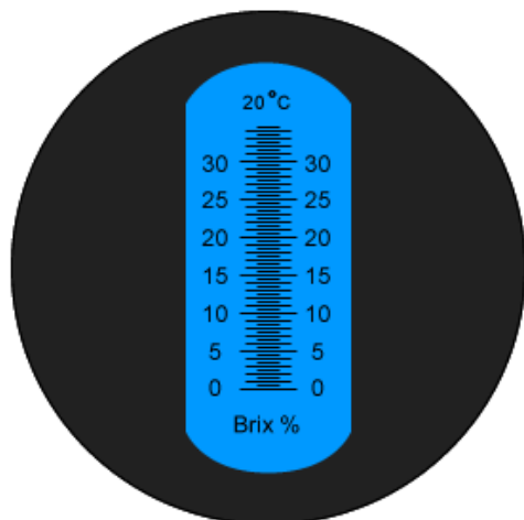
Шкала некалиброванного прибора (шкала полностью окрашена синим цветом).
