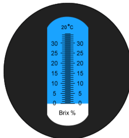
Шкала правильно калиброванного прибора (четкое соответствие границ синего и белого фона нулевой отметке).
